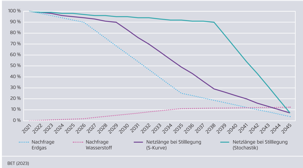
Annahmen zur Entwicklung der Gasnachfrage und Auswirkungen auf die Netzlänge im Erdgas- und Wasserstoffnetz für das städtische Modellnetz mit Industrie
